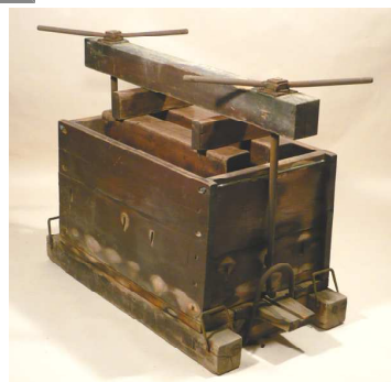
写真5 フネ（醤油しぼり機） 本体部分の幅 134cm・奥行 67cm・高さ 70cm。下南畑の巡回醤油屋が使用したものだ。
